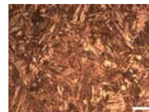
Kontrola struktury materiálu po tepelném zpracování
