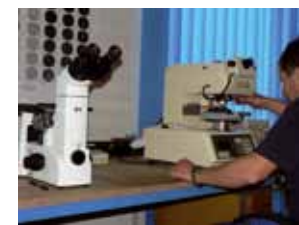
Měření tvrdosti jádra a povrchu
