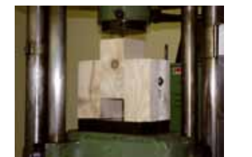
Model spoje - měření zatížení do porušení
